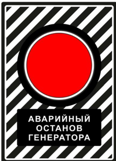
Кнопка «АВАРИЙНЫЙ ОСТАНОВ ГЕНЕРАТОРА» (рисунок 1 поз. 6) предназначена для экстренного (аварийного) останова электростанции в режиме автоматической коммутации. Для обеспечения безопасности кнопка аварийного останова используется при выполнении заправки электростанции топливом, при выполнении технического обслуживания или ремонтных работ.
