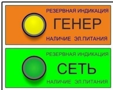
Резервные индикаторы «ГЕНЕР» (рисунок 2 поз. 2) и «СЕТЬ» (рисунок 2 поз. 4) расположены на передней панели и предназначены для индикации наличия электропитания на входе в изделие от бытовой сети и генератора электростанции соответственно.
