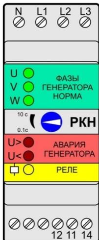
Если напряжение какой-либо фазы выходит за пределы 160-280 В, то соответствующий индикатор фазы генератора гаснет и реле отключается, гаснет индикатор «РЕЛЕ» - контакты 11 и 14 размыкаются.
