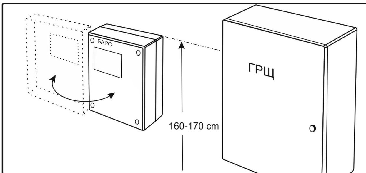
Разместите изделие, таким образом, чтобы обеспечить доступ ко всем компонентам изделия для удобной и безопасной эксплуатации и технического обслуживания. Мы рекомендуем установить и закрепить изделие на высоте 160-170 см от уровня пола слева от распределительного щита.
