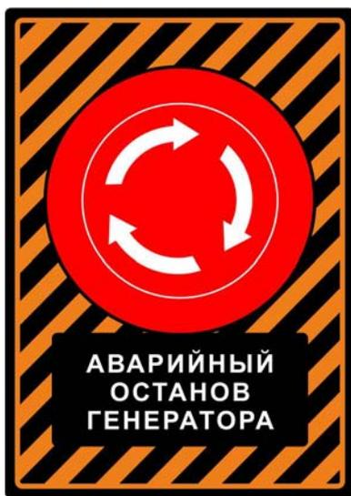
Кнопка «АВАРИЙНЫЙ ОСТАНОВ ГЕНЕРАТОРА» (рисунок 2 поз. 6) предназначена для экстренного (аварийного) останова электростанции в режиме автоматической коммутации. Для обеспечения безопасности кнопка аварийного останова используется при выполнении заправки электростанции топливом и при выполнении технического обслуживания или ремонтных работ.
