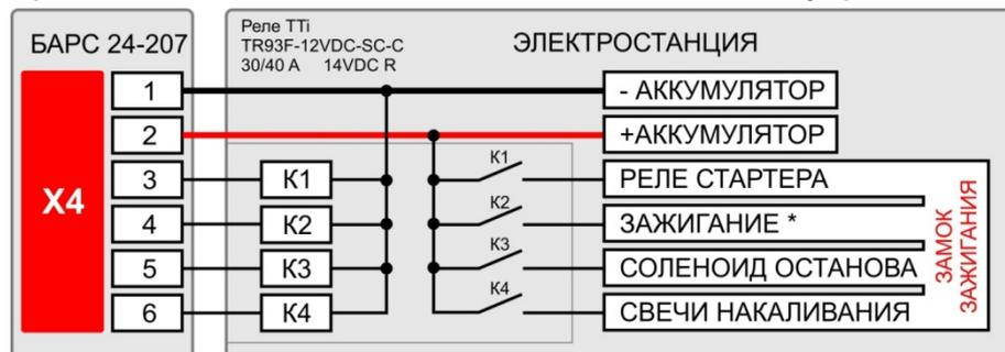
\* «Зажигание» управление соленоидом, топливным клапаном, исполнительным устройством включения зажигания.
