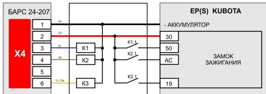
**ВНИМАНИЕ:** В автоматическом режиме ключ зажигания установить в положение «OFF»!
