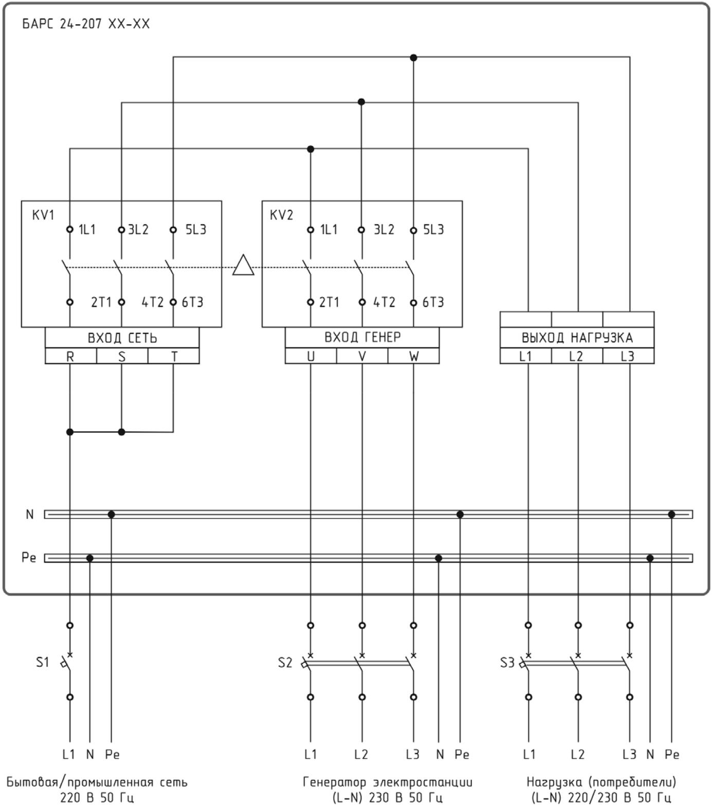
Приложение 5 – Подключение кабеля управления к электростанциям серии EPS с дизельными двигателями Kubota.
