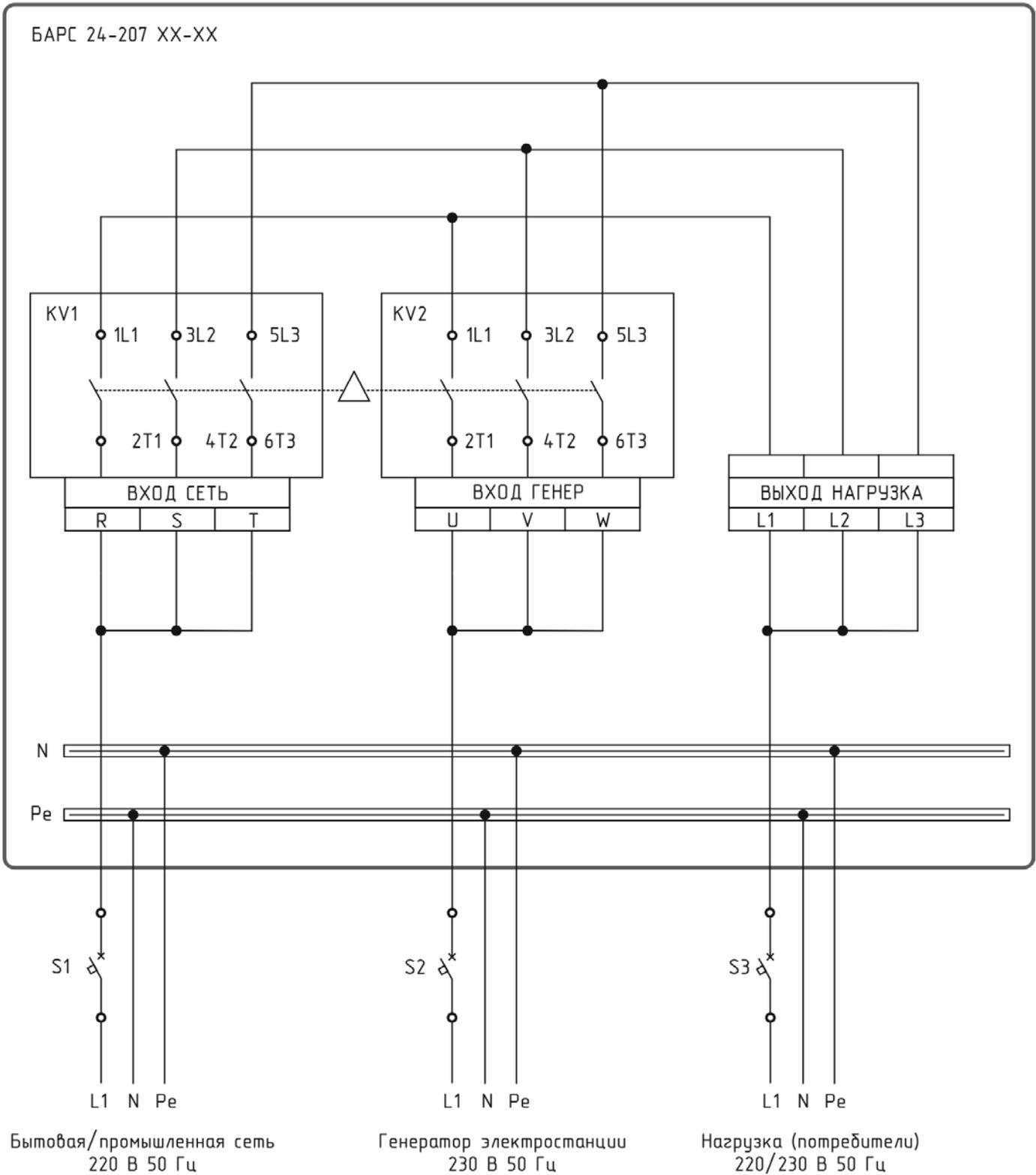
Приложение 4 - Однофазная сеть и трехфазная электростанция 400 В 50 Гц
