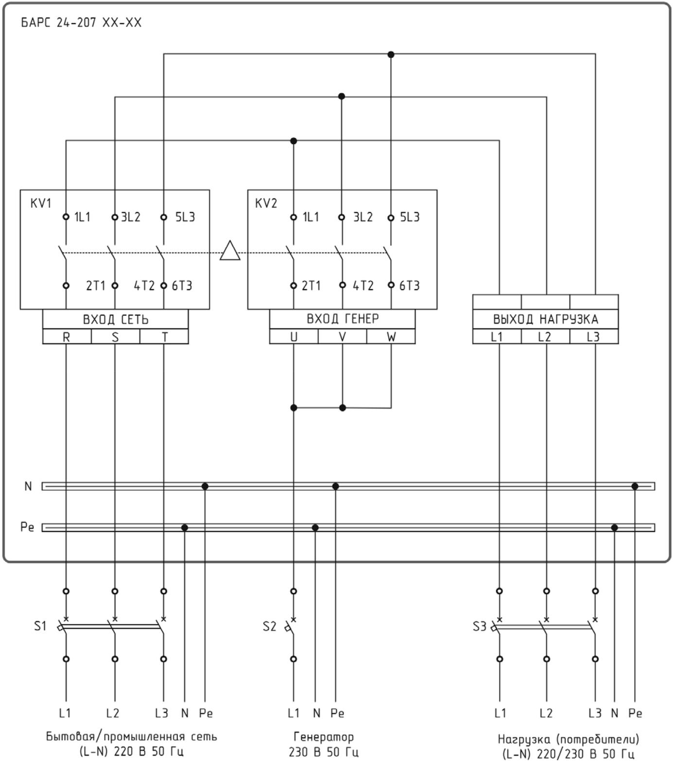
Приложение 3 - Однофазная сеть – однофазная электростанция 230 В 50 Гц
