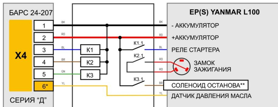
**ВНИМАНИЕ:** В автоматическом режиме ключ зажигания установить в положение «OFF»!
