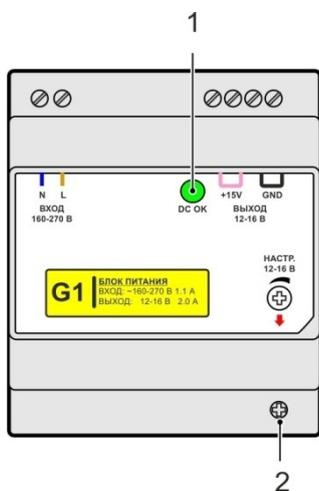
Блок питания запитывается только в автоматическом режиме работы от фазы сети при включенном контакторе «KV1». При наличии напряжения 12 В (24 В) высвечивается индикатор (рисунок 5 поз. 1).
